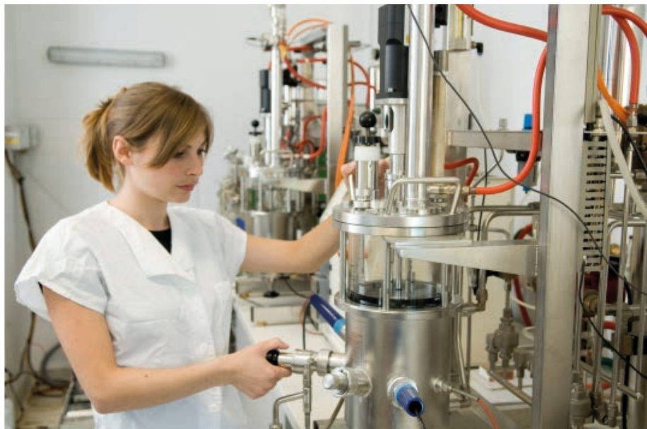
1. kép: Mikrobiológiailag tiszta metán termelő archaeák tenyésztése automatizált, steril laboratóriumi fermentorokban a Biotechnológiai Tanszék laboratóriumában.
