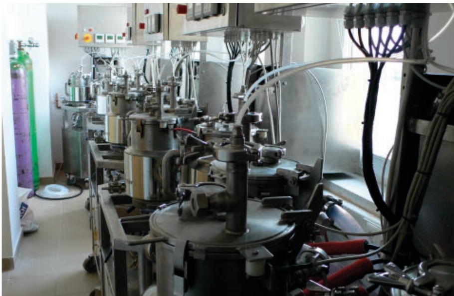
2. kép: Saját fejlesztésű, folyamatos üzemmódban működő 5 literes laboratóriumi biogáz reaktorok.
